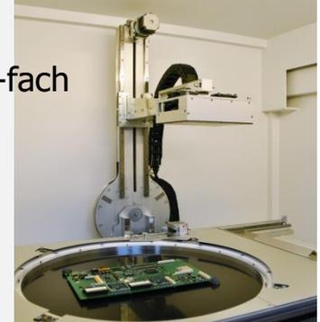
Bei der hochauflösenden Röntgenuntersuchung handelt es sich um eine Durchstrahlungsprüfung (Radioskopie), bei der sich das Werkstück zwischen der Röntgenröhre und einem Bilddetektor befindet.
